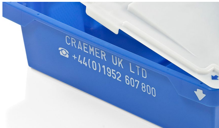
Napis wykonany metodą gorącego stempla
