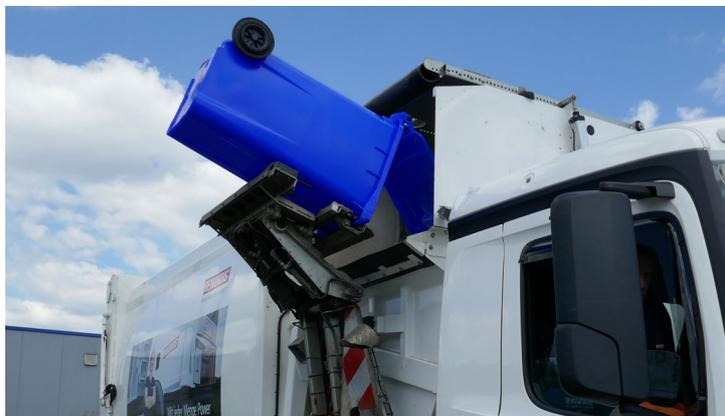
Prueba de elevación y vaciado
