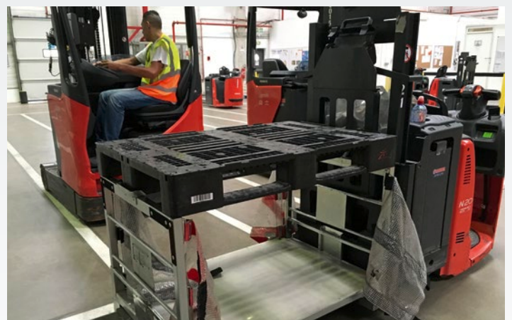
Los palets de plástico Craemer se posicionan en un bastidor de metal antes de empezar la preparación de pedidos en el almacén
