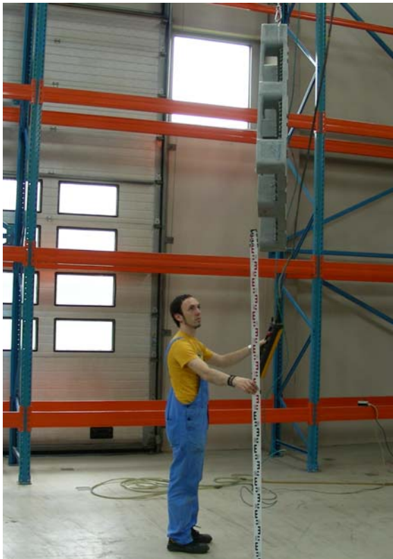
Abb. 2: Fallprüfung nach Vortemperierung
