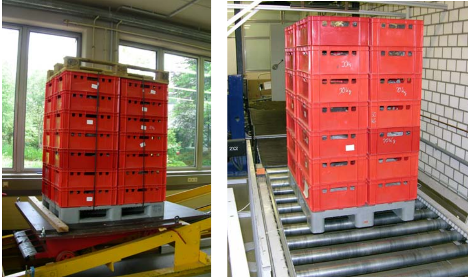
Abbildung 3 und 4: Prüfaufbau: horizontale Stoßprüfung, links, Rollenbahndauerprüfung, rechts
